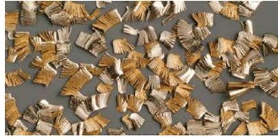
Le leghe di ottone senza piombo sono notoriamente considerate difficili da lavorare a causa della loro scarsa capacità di rottura dei trucioli. GloBrass ed ECOBRASS rappresentano un grande passo avanti grazie a un miglioramento nelle prestazioni di rottura dei trucioli, aumentando la sicurezza e l'affidabilità del processo di lavorazione.
