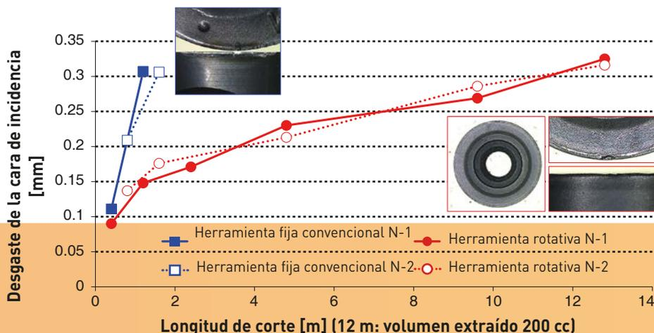
Condiciones de corte:  $v_c=30$  m/min  $f_z = 0,1$  mm/t  $a_p = 1,0$  mm  $a_e = 18$  mm Pieza de trabajo de mecanizado de punto único / procesamiento húmedo: INCONEL®718
