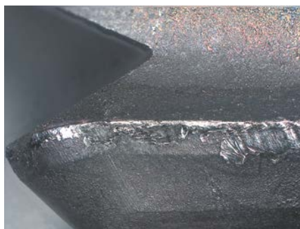
Zustand der Schneidkante nach dem Fräsen
