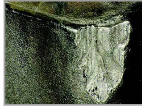
Kaynak talaşı kaynaklı kırılma
