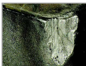
Wyłamywanie krawędzi spowodowane narostem
