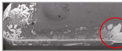
Herkömmlich C: Abrieb der Beschichtung
