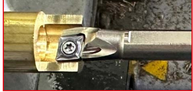
Çukurlu Bara Minimum işleme çapı 10 mm
