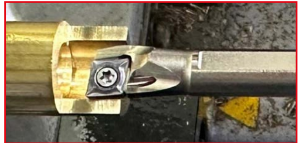
Dimple bar Diamètre de passage minimum 10 mm
