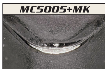
Usura 0,29 mm Dopo la lavorazione di 30 pezzi.
