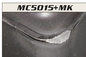
Usura 0,44 mm Dopo la lavorazione di 17 pezzi.
