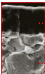
Çok çeşitli uygulamalar için uygun PVD kaplamalı kalite. Özel sert sinterlenmiş karbür altının MIRACLE kaplama ile kombinasyonu aşınma ve kırılma direncinin mükemmel bir dengesini sağlar.
