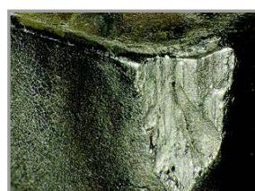
Kaynak talaşı kaynaklı kırılma
