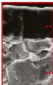
Revêtement PVD, nuance adaptée à une grande gamme d'applications. La combinaison d'un substrat carbure robuste et du revêtement MIRACLE assure une excellente résistance à l'usure et à l'écaillage.
