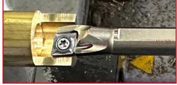
Çukurlu Bara Minimum işleme çapı 10 mm
