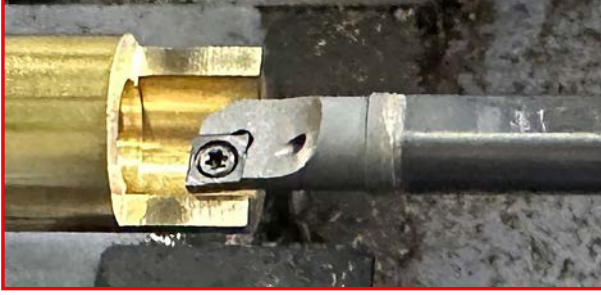
Küçük parçaların işlenmesi için Delik İşleme Barası Minimum işleme çapı 9 mm
