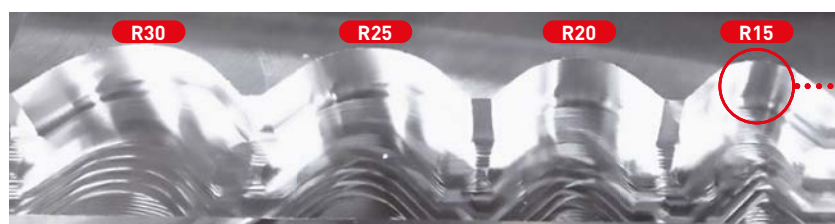
Vc = 200 m/min, R15, Imagen realizada después del mecanizado
