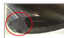
Defecto por falta de resistencia
