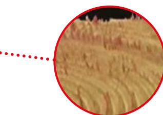
W miejscu o niskiej prędkości skrawania (blisko osi) chropowatość powierzchni może być większa
