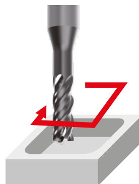
Frezowanie wgłębień (kieszeni)
