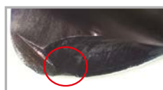
Uszkodzenie wskutek dużego obciążenia
