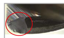
Uszkodzenie wskutek zbyt niskiej wytrzymałości
