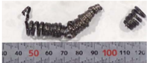
Butzenbildung im Zentrum: \varnothing 0.58 mm, Rz: 0.043 mm
