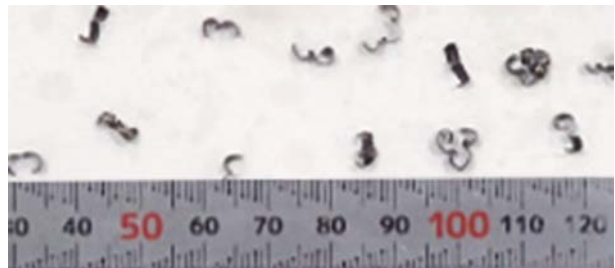
Butzenbildung im Zentrum: \varnothing 1.42 mm, Rz: 0.015 mm
