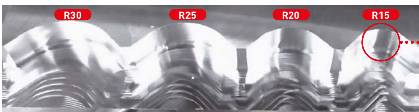
Vc = 200 m/min, R15, Bearbeitungsergebnis
