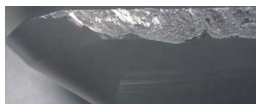
Esempio di rottura da shock termico
