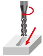
Capacità di rampa con angoli molto elevati
