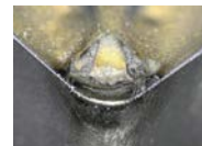
Трещины образовались после механической обработки 185 заготовок
