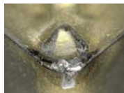
Трещины образовались после механической обработки 185 заготовок
